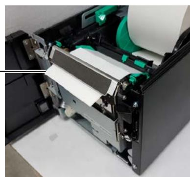
13. Рычагом положения головки изменяйте усилие поджатия печатающей головки в соответствии с толщиной применяемой ленты.
