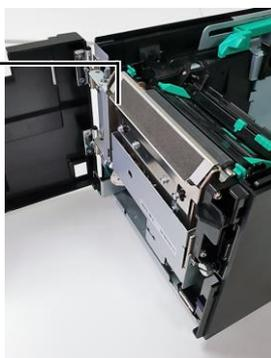
4. Очистите элемент печатной головки очистителем печатной головки - ватным тампоном или мягкой тканью, слегка смоченной чистым этиловым спиртом. При повороте вала шагового двигателя резака нож поднимается и опускается.
